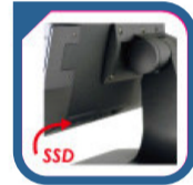
La unidad de estado sólido (SSD) se encuentra ubicada en la parte trasera del monitor y es de fácil mantenimiento.
